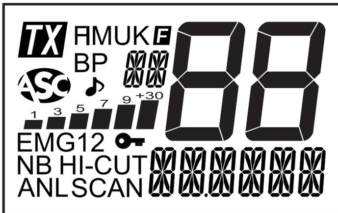
Die 6-stufige BALKENGRAFIK zeigt den rel. Empfangspegel (RX) bzw. rel. Ausgangsleistung (TX) an.
